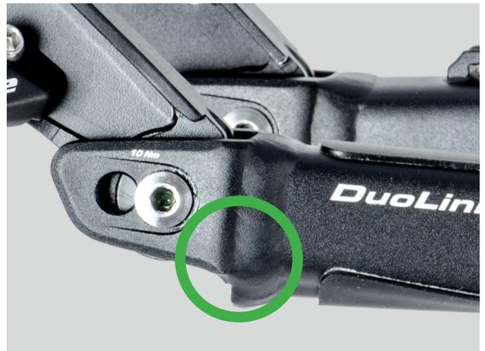
Abb. zeigt Zugaustritt Kettenstrebe
