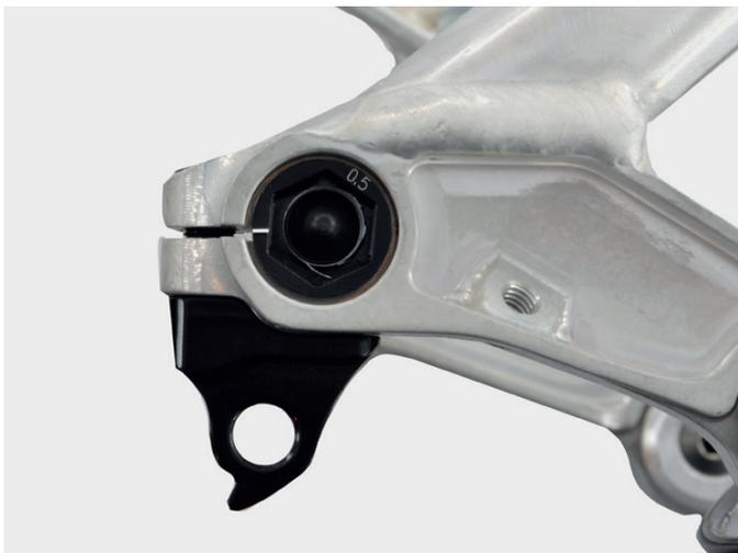
Abb. zeigt: Insert mit Klemmschlitz korrekt ausgerichtet
