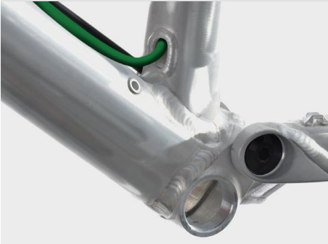
Abb. zeigt: Zugverlegung Vario-Stütze im Sitzrohr
