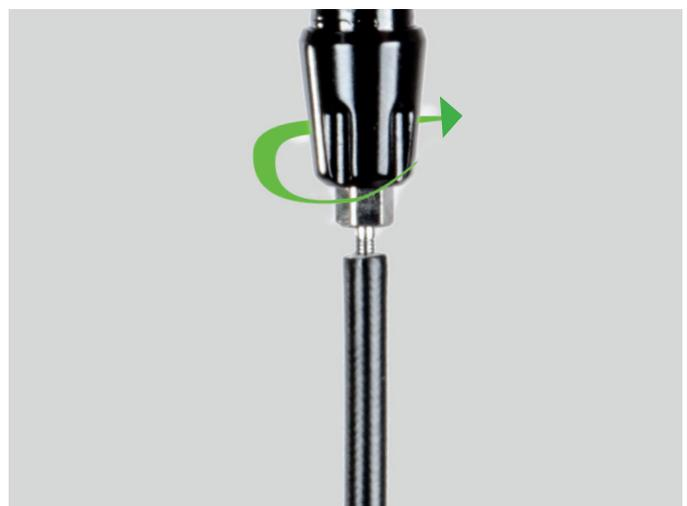
Schritt 4: Leitung kürzen und mit Lenkerfernbedienung verbinden
