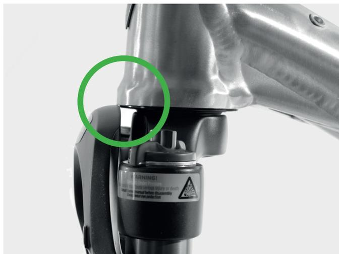
Abb. Freiraum zum Steuerrohr
