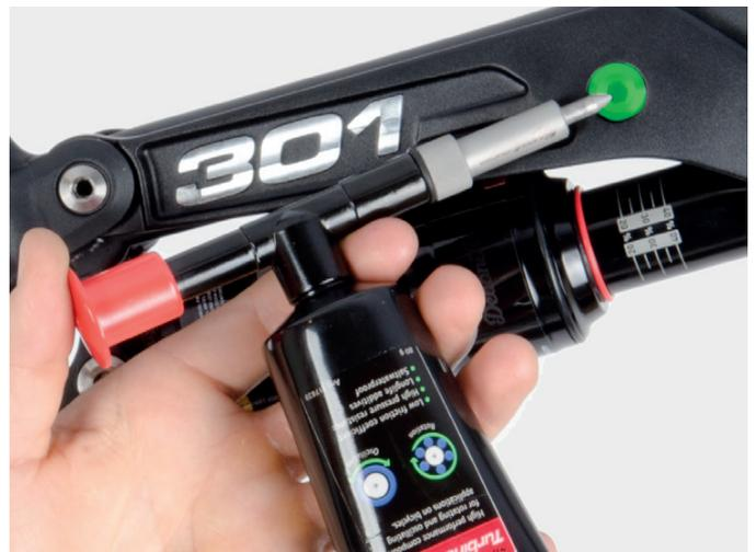
Abb. zeigt: Abschmierbare Lagerstelle am Oberrohr
