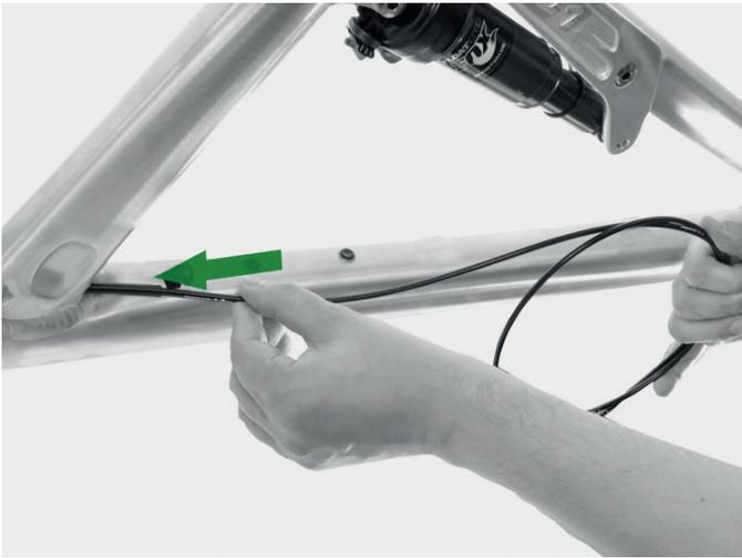
Abb. zeigt: Zugwechsel
