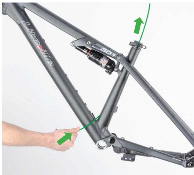
Schritt 1: Einfädelhilfe unten einfädeln und durchschieben
