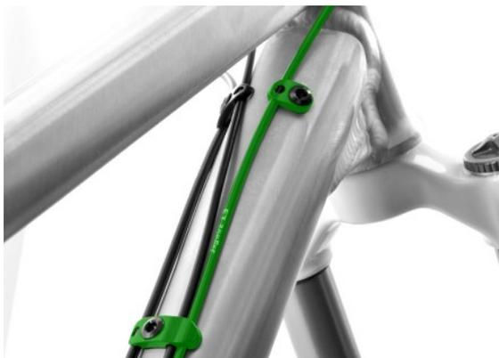
Verwenden Sie für die Verlegung des Hammerschmidt-Zuges rechts um das Steuerrohr herum die beiliegende 1-fach Klemme.
