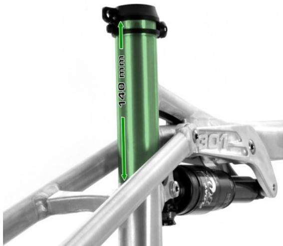
Um einen Rahmendefekt zu vermeiden muss die Sattelstütze mindestens bis zu der am Sitzrohr angebrachten Markierung eingeschoben sein. Works Finish Rahmen haben keine Lasermarkierung, halten Sie sich deswegen aber genau so an unsere Mindesteinstecktiefe-Vorgabe von 140 mm (Bild links).
