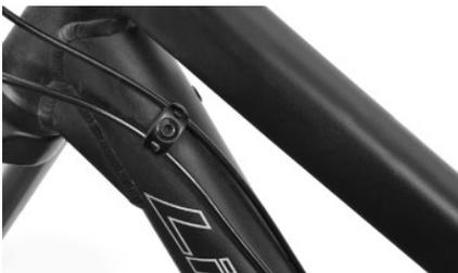
Nun können Sie den hinteren Schalt- und Bremszug mit den Zughaltern auf den Zughalter-Pads montieren und erreichen hierdurch eine optimale Zugverlegung. Wir empfehlen die Verlegung der Züge wie hier abgebildet links um das Steuerrohr herum. Auf diese Weise vermeiden Sie Scheuerstellen am Rahmen und die Freigängigkeit beim Einlenken bleibt gewährleistet.
