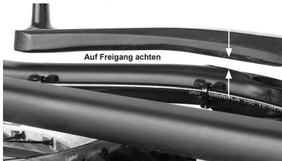
Es können evtl. nicht alle auf dem Markt erhältliche Kurbel/Tretlager Einheiten verwendet werden. Die Tretlager-Gehäusesebreite beträgt 73 mm.
