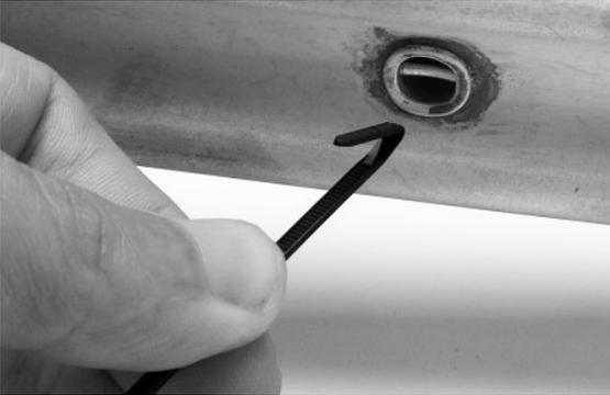
Bevor die Schaltzughülle für den Umwerfer montiert werden kann, muss zuvor das Federbein an der vorderen Aufnahme ausgehängt und vorsichtig nach unten weggeklappt werden. Zum Befestigen der Schaltzughülle befinden sich an der Unterseite des Oberrohrs spezielle Leitungshalterungen.
