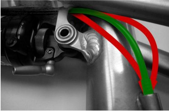
Der Schaltzug verläuft zwischen Oberrohr und Federbein. Lassen Sie den Schaltzug zwischen der linken hinteren Federbeinaufnahme und dem Sitzrohr her austreten.
