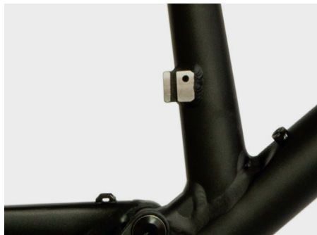
Abb.: Freiraum zwischen Kettenführung und Kettenstreben
