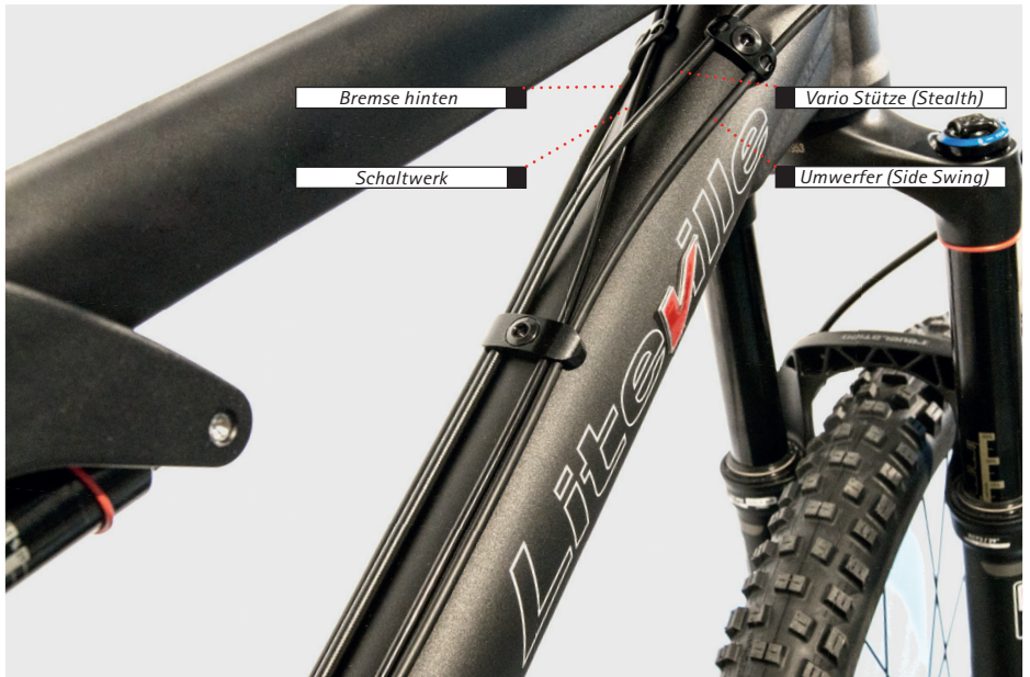
Abb. zeigt: Beispielhaft 2x11 Antriebseinheit, Bremseinheit und Vario-Stütze am Unterrohr
