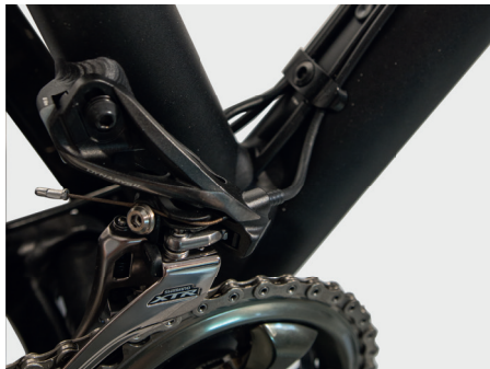
Shimano Sideswing Umwerfer inkl. ersten Zughalter am Unterrohr
