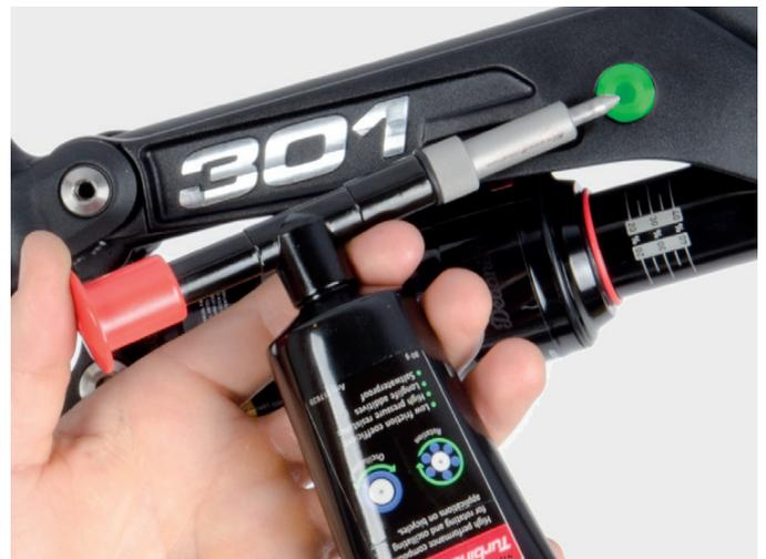
Abb. zeigt: Abschmierbare Lagerstelle am Oberrohr
