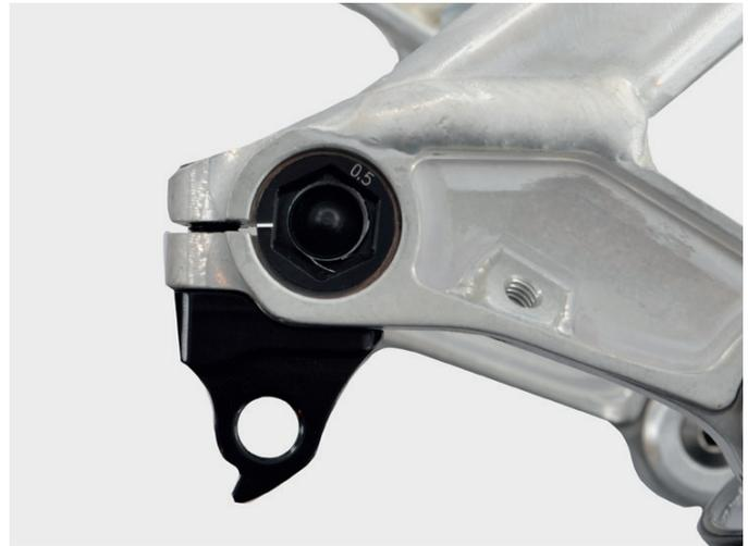
Abb. zeigt: Insert mit Klemmschlitz korrekt ausgerichtet
