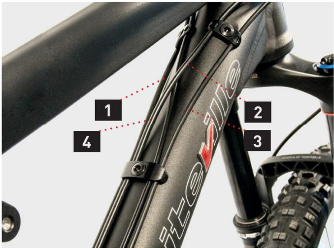
Abb. zeigt: Beispielhaft 2x11 Antriebseinheit, Bremseinheit und Vario-Stütze am Unterrohr
