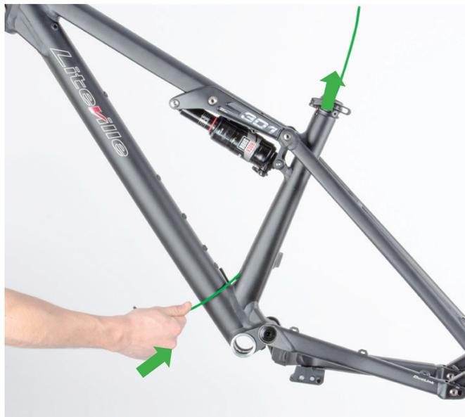
Schritt 1: Schaltzug unten einfädeln und durchschieben
