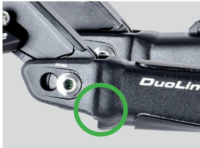
Abb. zeigt Zugaustritt Kettenstrebe
