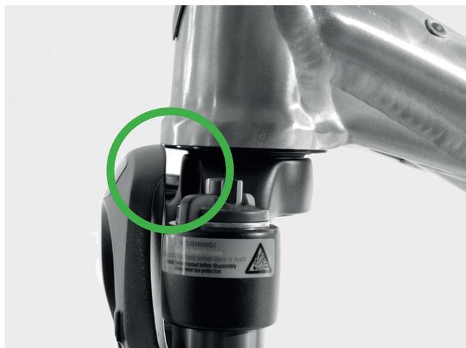
Abb. Freiraum zum Steuerrohr
