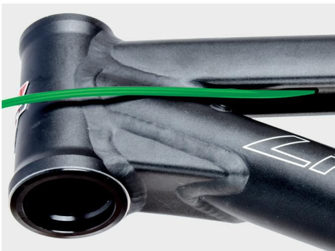
Abb. zeigt Zugeintritt Oberrohr & Steuerrohr
