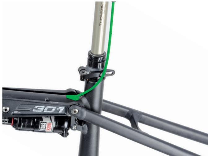
Abb. zeigt Zugeintritt am Oberrohr & Sitzrohr
