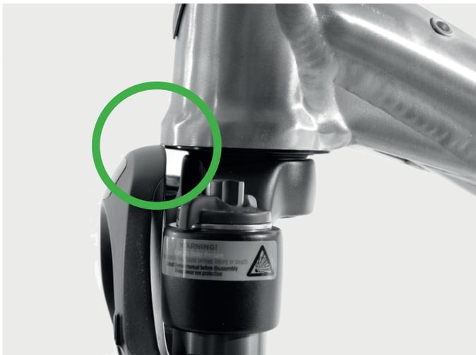
Abb. Freiraum zum Steuerrohr
