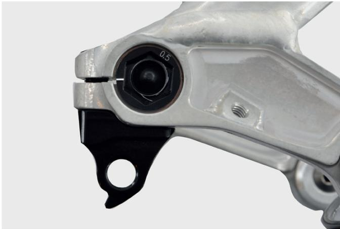
Abb. zeigt: Insert mit Klemmschlitz korrekt ausgerichtet
