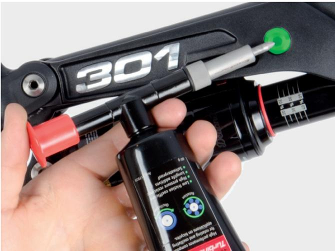
Abb. zeigt: Abschmierbare Lagerstelle am Oberrohr
