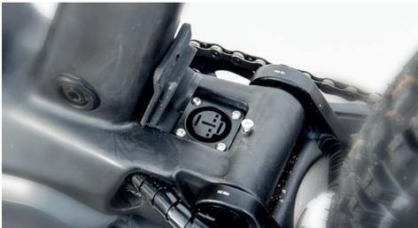
Abb.: Ladebuchse beim 301CE Mk1 ( ohne Upgrade )
