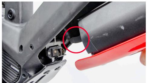
Abb.: Einfügen mittels Führungszapfen
