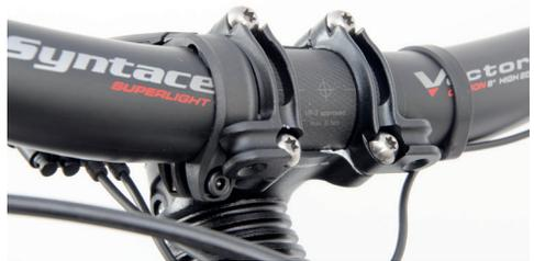
Abb.: Twin Fix Schnittstelle ( nur serienmässig bei Mk1 Pro )
