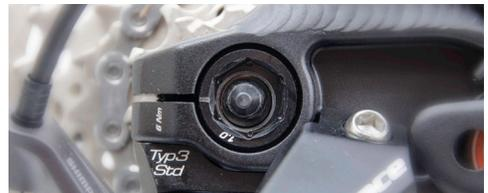
Abb.: Korrekt ausgerichtetes Insert mit Klemmschlitz
