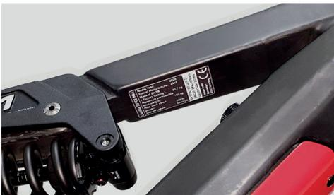
Abb.: Typenschild and der unterseite des Oberrohres
