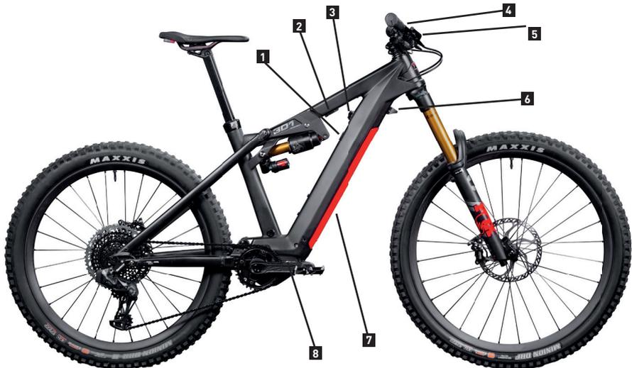
Abb.: Liteville 301CE Mk1 AIR.LIMITED mit Shimano EP8 und Ladeport am Oberrohr
