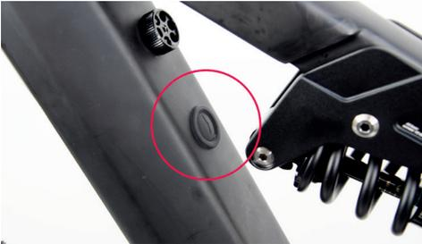
Abb.: Ein- / Ausschalter am Unterrohr
