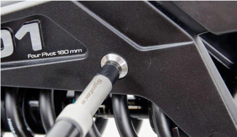
Abb.: Abschmierbare Lagerstelle am Oberrohr
