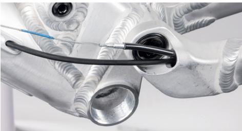
Führe wie zuvor bei der Schalttaußenhülle die Bremsleitung aus der Kabelöffnung heraus.
