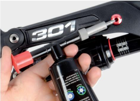
Abb. zeigt: Abschmierbare Lagerstelle am Oberrohr
