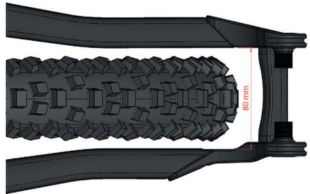
Dein 303 Mk1 hat an der Kettenstrebe ca. 77 mm Reifenfreiheit. Wir empfehlen folgende Reifenbreiten:
