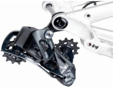
**HINWEIS:** Stelle sicher, daß der SRAM UDH Hanger mit 25 Nm am Rahmen festgezogen ist ( Linksgewinde! ).
