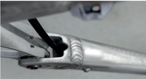
Schiebe jetzt die Bremsleitung von hinten durch die Kettenstrebe bis zum vorderen Ausgang am Tretlager. Achte darauf dass die Bremsleitung unter dem Cable Pulley verläuft.
