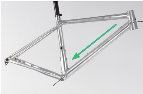
2. am Tretlager auf der rechten Seite wieder heraus holen.
