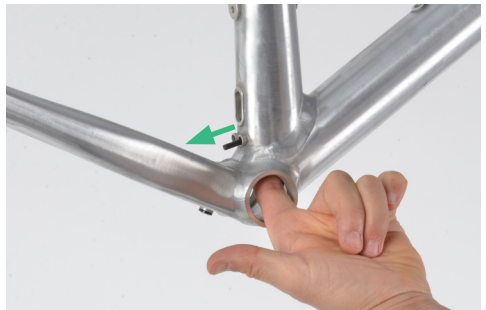
5. Schaltaußenhülle mit dem Finger nach oben zum rechten Ausgang im Sitzrohr führen und gleichzeitig vom oberen Ende am Steuerrohr schieben.
