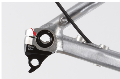
Abb. zeigt: Insert mit Klemmschlitz korrekt ausgerichtet
