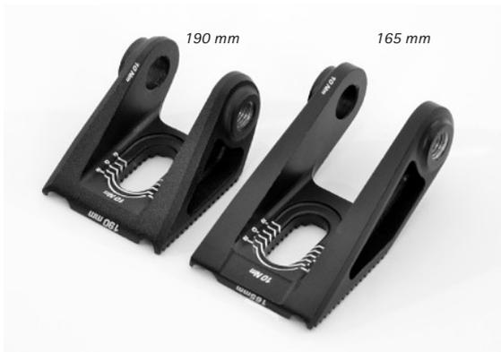
**Achtung:** Verwenden Sie für die unterschiedlichen Federbeinlängen die entsprechenden (dem Rahmen beiliegenden) Federbeinaufnahmen. Die 190 mm Federbeinaufnahme muss für Federbeine mit 240 mm Einbaulänge verwendet werden. Die 165 mm Federbeinaufnahme muss für Federbeine mit 222 mm Einbaulänge verwendet werden.
