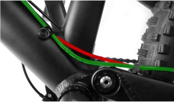
Die Schaltzughüllen werden durchgehend verlegt. Bitte ziehen Sie die Schrauben der Halteklammern nur leicht an. Die Halteklammern sollen die Züge nur gegen „verrutschen“ sichern. Bei zu starkem Festziehen der Halteklammern werden die Brems- und Schaltzüge gequetscht, was die Funktion stark beeinträchtigt.
