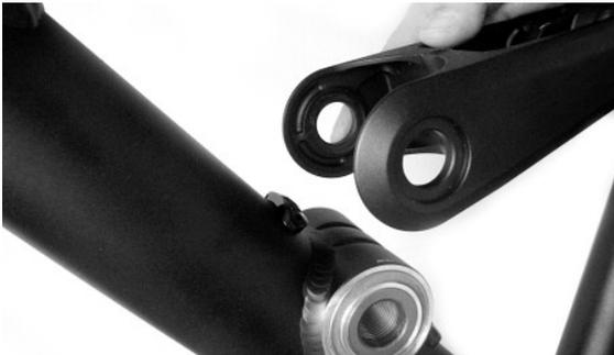
3. Nun kann die Bremsleitung mit Bremssattel durchgefädelt und anschließend der Umlenkhebel samt Federbein wieder montiert werden.
