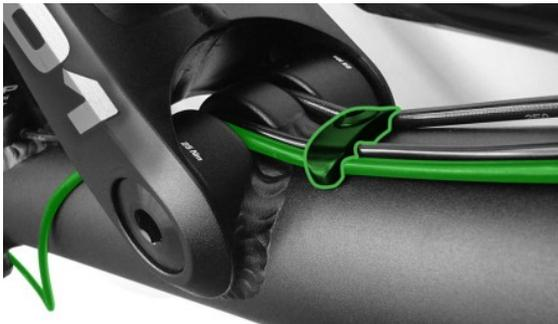
Ersetzen Sie die am Rahmen befestigte 2-fach Klemme durch die im HammerSchmidt-Kit befindliche 3-fach Klemme. Nach der Durchführung unter dem Umlenkhebel verläuft der Schaltzug, nach der Klemmung, direkt in das Gehäuse der HammerSchmidt-Kurbel.
