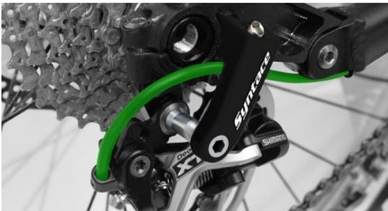
Der Schaltzugausgang befindet sich am unteren Ende der rechten Kettenstrebe.
