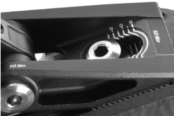
Schraube ganz unten bedeutet: „flachste Winkelseinstellung“ und „tiefes Tretlager“.
