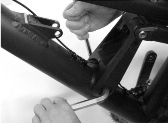
Nach dem Entfernen der ersten Schraube mit einem 10 mm Inbusschlüssel, muss innen die Achse mit einem 14 mm Inbusschlüssel gegengehalten werden, um die zweite Schraube zu lösen.
