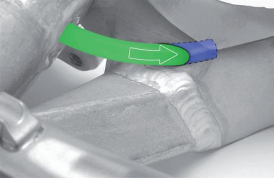
Der Schaltzug für das Schaltwerk wird auf direktem Weg durch das Sitzrohr direkt in die Kettenstreben geführt. Um den Zug noch besser vor Verschleiß zu schützen, verwenden wir ein zusätzliches flexibles Schutzröhrchen.
