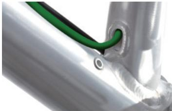
Das Liteville 601 Mk2 ist für die Montage einer Rock Shocks Stealth Variostütze vorbereitet. Der Zugeingang in das Sattelrohr befindet sich auf der linken unteren Seite, unten am Sattelrohr. Verlegen sie die Leitung der Rock Shocks Stealth Sattelstütze laut Rock Shocks Anleitung.
