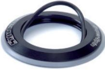
Montieren Sie zunächst die beiden Dichtungsringe (graue Dichtlippe außen und schwarzer O-Ring innen) am Abdeckring des SuperSpinn-Steuersatzes.
