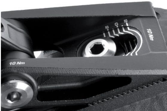
Schraube ganz unten bedeutet: „flachste Winkeleinstellung“ und „tiefes Tretlager“.
