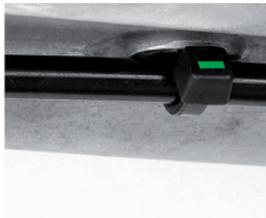
Den Kabelbinder bündig am Kopf abzwicken (z.B. mit Präzisions-Seitenschneider) und die Köpfe anschließend ganz an das Rahmenrohr drehen, so dass diese nicht unten überstehen
