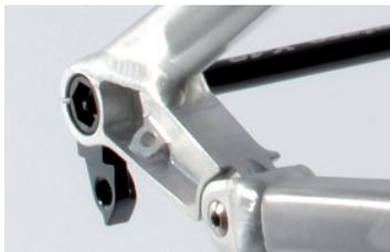
Integrierte Anschlußstelle für den patentierten Syntace RockGuard Schaltwerksschutz. Statt dauernden Ärger mit verstellten Schaltungen und ständig schiefen „Soft-Schaltanlagen“... bombenstabile, zuverlässige Funktion 365 Tage im Jahr.
