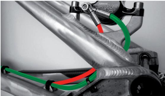
Bitte beachten Sie, dass sich die Bremsleitung beim Einfedern des Hinterbaus verkürzt und verlegen Sie die Leitung ausreichend lang!
