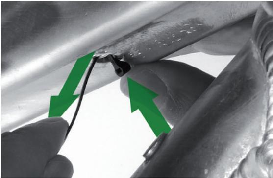
Durch ziehen und gleichzeitigem schieben können Sie jetzt den Kabelbinder ganz bis zum Ende durchfädeln, so dass der Kopf am Rahmen anliegt. Die Kabelbinder-Köpfe ohne Gewaltanwendung zur Seite hin drehen, so stehen sie nicht unnötig und hässlich ab. Nun den Schaltzug für den Umwerfer (eventuell auch die Leitung für eine verstellbare Sattelstütze) befestigen. Achtung: Den Kabelbinder ohne Werkzeug nur handfest zuziehen.
