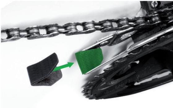
**Tipp:** Im Lieferumfang befindet sich ein Klebepad für den Umwerfer. Montieren Sie diesen wie abgebildet, um das Kettengeräusch beim Anschlagen der Kette an den Umwerfer zu reduzieren.
