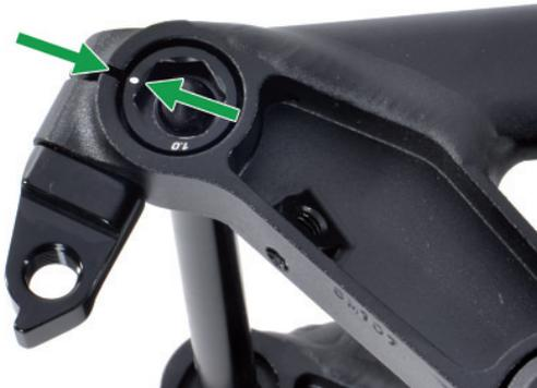
Die Inbusschraube am rechten Ausfallende dient ausschließlich zur Befestigung des Schaltauges und zur Klemmung des Achsinserts. Sie muss zum Achsausbau nicht geöffnet werden!
