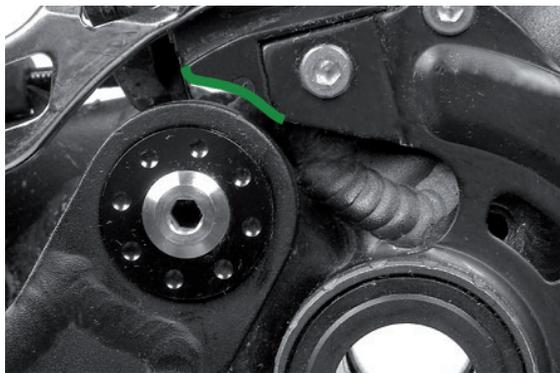
Je nach verwendetem Shimano E-Type Umwerfer muss dieser für den 601 Rahmen eventuell wie abgebildet ein wenig angepasst werden, damit er am Schwingenlager vorbeipasst. Hierbei handelt es sich nicht um einen Konstruktionsfehler, sondern um eine bewusste Positionierung des Hinterbau-Hauptlagerdrehpunktes für eine optimale Kinematik und maximale Steifigkeit.
