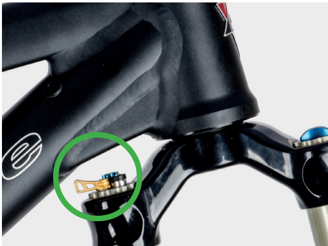
Abb. Freiraum zum Unterrohr
