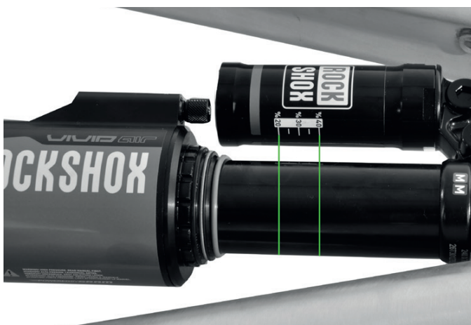
Abb. zeigt SAG ablesen am Dämpfer
