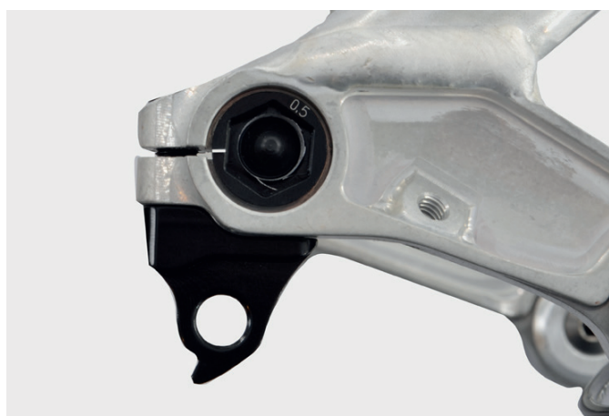
Abb. zeigt: Insert mit Klemmschlitz korrekt ausgerichtet
