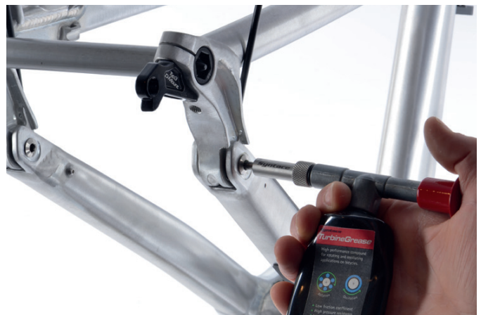
Abb. zeigt: Abschmierbare Lagerstelle am Horst-Link
