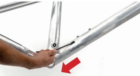
Abb.: Herausziehen aus dem Unterrohr
