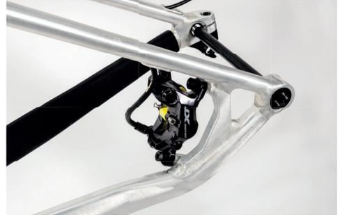
Abb.: Bremsattel auf PM mit Leitungsabgang Shimano.
