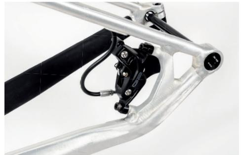
Abb.: Bremsattel auf PM mit Leitungsabgang SRAM.
