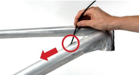
Abb.: Einfädeln am Unterrohr.
