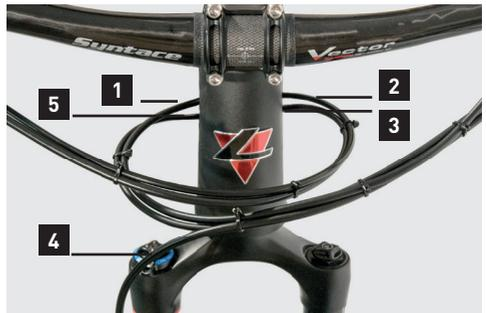
Abb.: Beispielhaft 2x11 Antriebseinheit, Bremseinheit und Vario-Stütze von vorne
