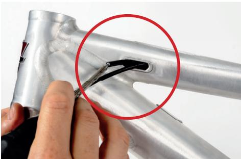
Abb.: Ausgang Bremsleitung Oberrohr.
