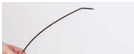
Abb. 15: Außenhülle mit Knick und 45° Anschnitt.
