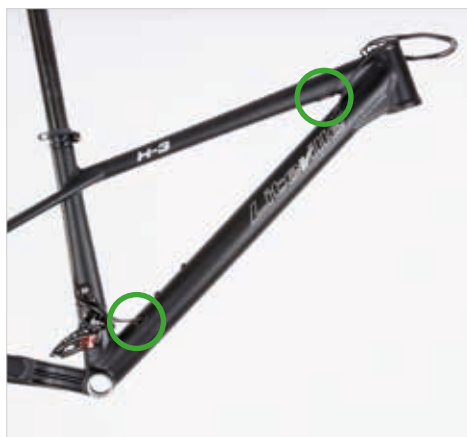
Abb. 17: Verlegte Shimano XT Side-Swing Außenhülle / Ein- und Ausgang.
