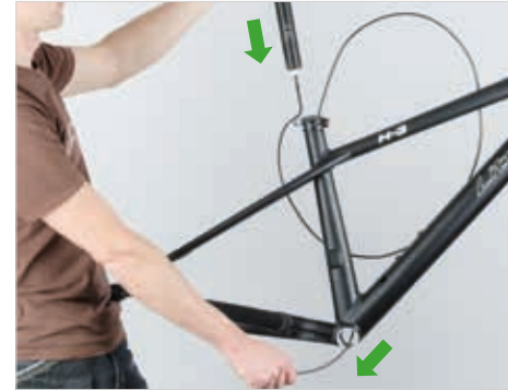
Abb. 27: Reverb Leitungsdurchführung im Sitzrohr.
