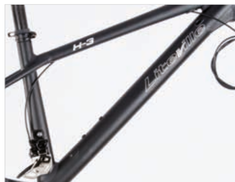
Abb. 14: SRAM / Zugführung im Oberrohr.
