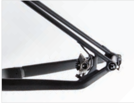
Abb. 22: Bremsattel auf PM mit Leitungsabgang Shimano.
