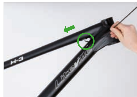
Abb. 18: Einfädeln am Oberrohr.
