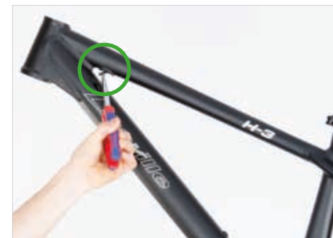
Abb. 21: Ausgang Bremsleitung Oberrohr.
