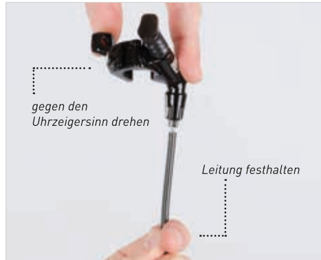
Abb. 25: Trennung des Reverb Hebels von der Leitung
