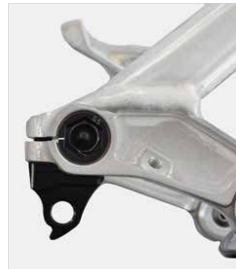
Abb. 02: Insert mit Klemmschlitz korrekt ausgerichtet.
