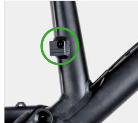
Abb. 10: Abdeckung des DirectMount Sockels.
