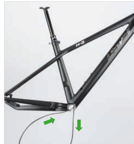
Abb. 28: Leitungsverlegung vom Sitzrohr in das Unterrohr.
