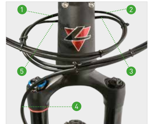
Abb. 13: Beispielhaft 2x11 Antriebseinheit, Bremseinheit und Vario-Stütze von vorne.
