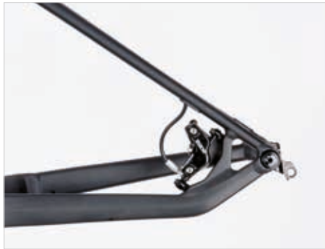
Abb. 23: Bremsattel auf PM mit Leitungsabgang SRAM.
