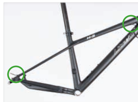
Abb. 19: Außenhülle Schaltwerk / Ein- und Ausgang.
