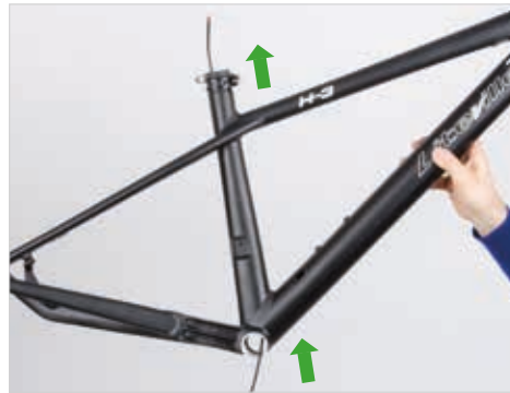
Abb. 24: Verlegte Montagehilfe im Sitzrohr.
