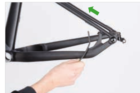
Abb. 20: Einfädeln an der Sitzstrebe.
