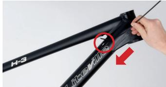
Abb.: Einfädeln am Unterrohr.
