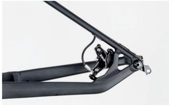
Abb.: Bremssattel auf PM mit Leitungsabgang SRAM.
