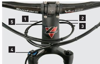
Abb. zeigt: Beispielhaft 2x11 Antriebseinheit, Bremseinheit und Vario-Stütze von vorne
