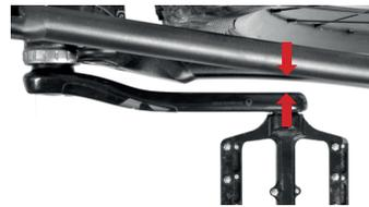
Abb. zeigt Freigang zwischen Kettenstrebe und Kurbel
