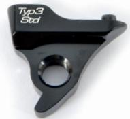
Abb. 05: Std.-Schaltauge für Shimano-Shadow und SRAM.
