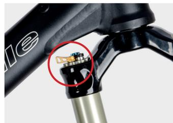
Abb. Freiraum zum Unterrohr
