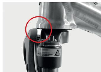
Abb. Freiraum zum Steuerrohr
