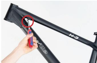
Abb.: Ausgang Bremsleitung Oberrohr.
