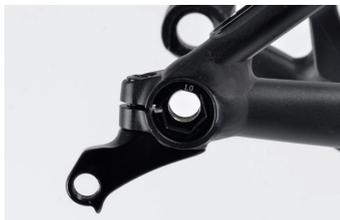
Abb. zeigt: Insert mit Klemmschlitz korrekt ausgerichtet
