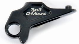
Abb. 06: Shimano Direct Mount Schaltauge.
