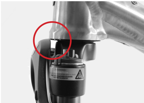
Abb.: Freiraum zum Steuerrohr
