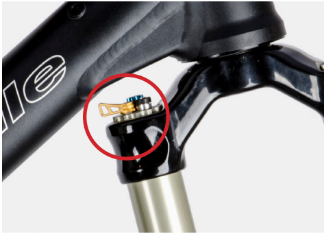
Abb.: Freiraum zum Unterrohr
