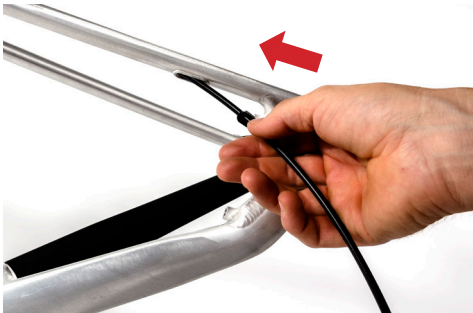
Abb.: Einfädeln an der Sitzstrebe.
