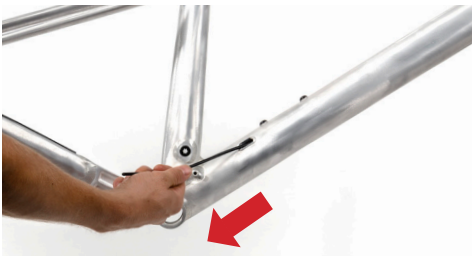
Abb.: Herausziehen aus dem Unterrohr
