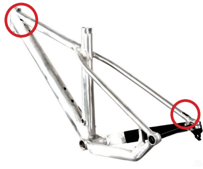
Abb.: Außenhülle Schaltwerk / Ein- und Ausgang.
